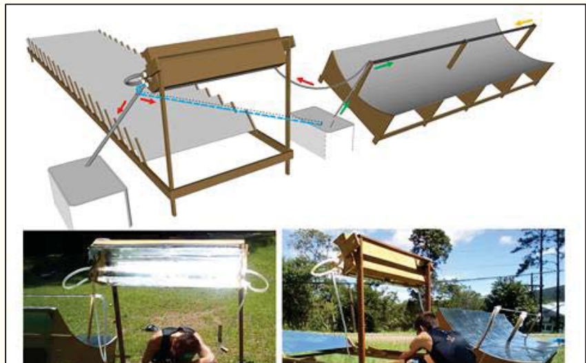
Sistema para tratamento solar de água
